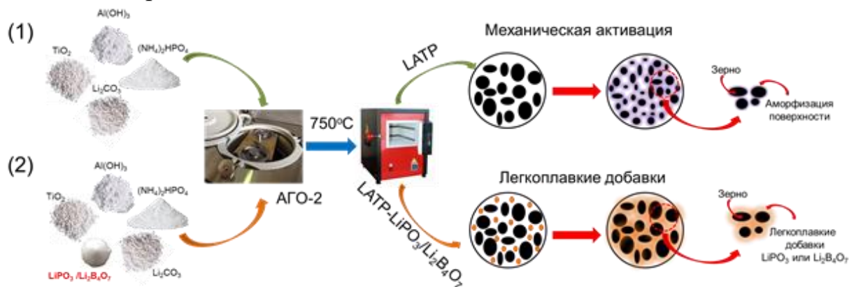
Схема синтеза твердого электролита \text{Li}_{1,3}\text{Al}_{0,3}\text{Ti}_{1,7}(\text{PO}_4)_3 с использованием механической активации в мельнице АГО-2 и введением легкоплавких добавок \text{LiPO}_3 и \text{Li}_2\text{B}_4\text{O}_7 .
