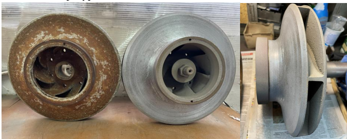
Рабочее колесо пожарного насоса НЦПН-40/100: слева – изношенное колесо, справа – восстановленное методом плазменного напыления.
